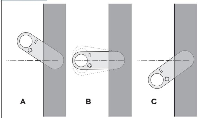
La régulation de l'air de combustion est continue lorsqu'on manoeuvre le régulateur d'air de combustion avec la porte du foyer fermée.
