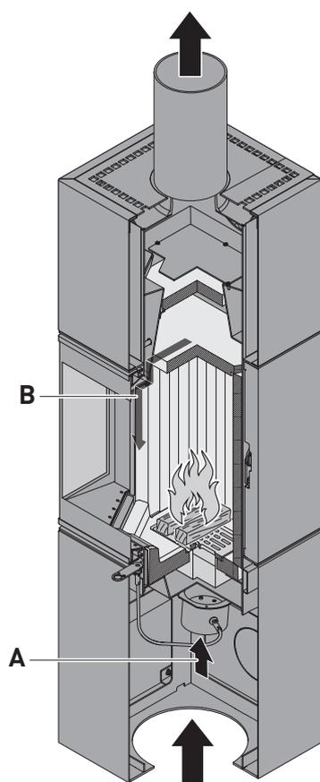
L'air de combustion est réparti en deux types de flux d'air :
