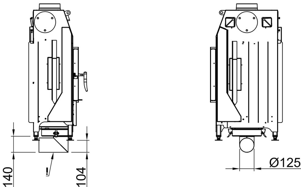
!: El uso del Boquilla de aire de combustión excéntrica sólo es posible con un soporte elevado del inserto de la chimenea.
