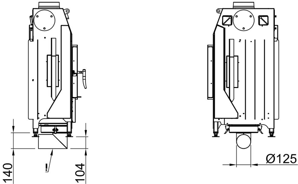
!: La Buse excentrique d'arrivée d'air extérieur ne peut être utilisé que lorsque la foyer encastrable est soulevée!
