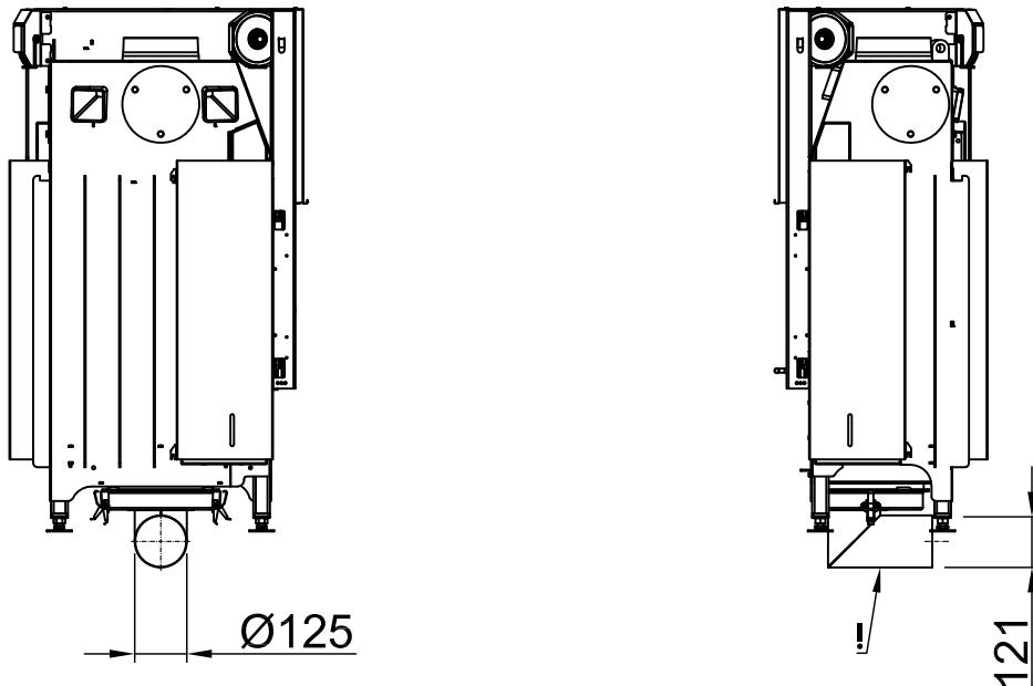
! La utilización de la pieza de conexión del aire de combustión excéntrica sólo es posible si la célula de combustión está elevada.
