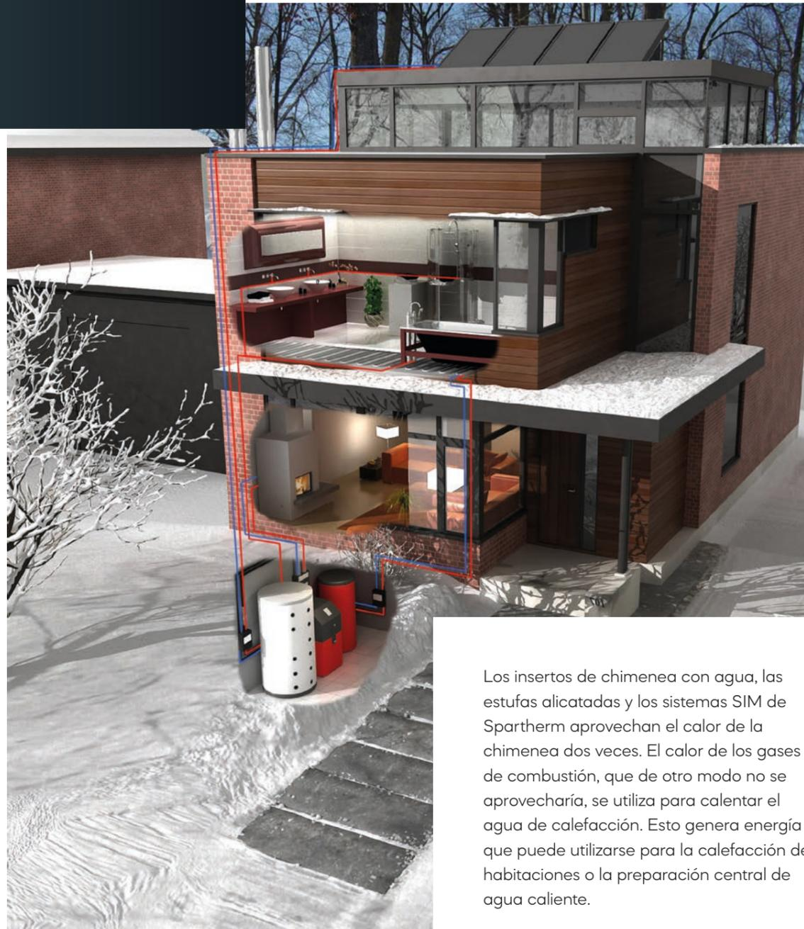
Los insertos de chimenea con agua, las estufas alicatadas y los sistemas SIM de Spartherm aprovechan el calor de la chimenea dos veces. El calor de los gases de combustión, que de otro modo no se aprovecharía, se utiliza para calentar el agua de calefacción. Esto genera energía que puede utilizarse para la calefacción de habitaciones o la preparación central de agua caliente.
