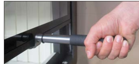
Positionner «l'outil opérationnel» sur le point de connexion
